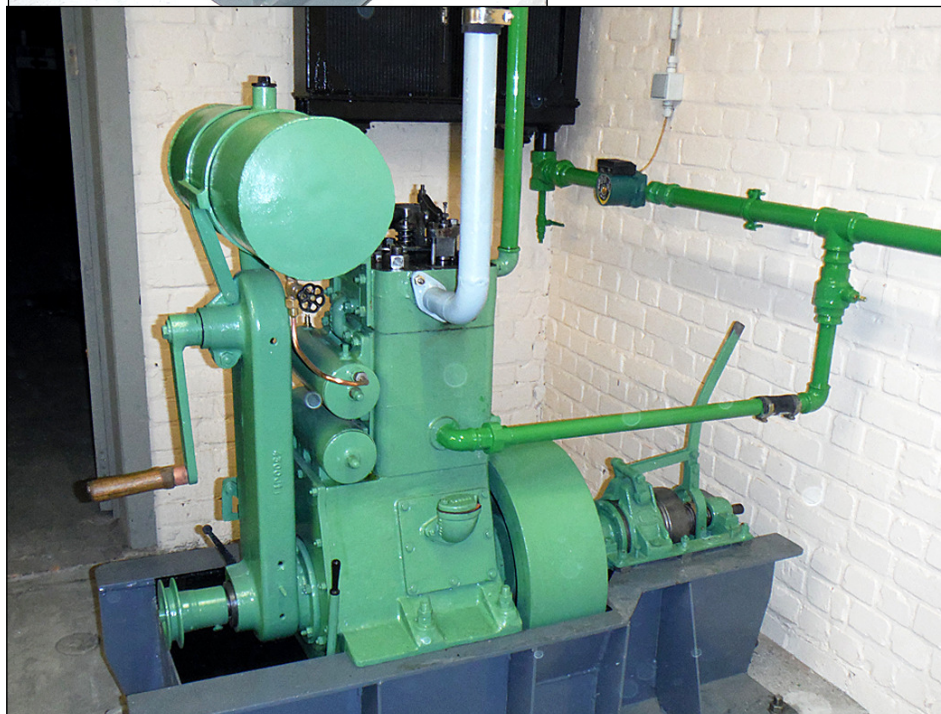
Hieronder een zeldzame Claeys scheepsdieselmotor Type J1 uit de Werkhuizen Leon Claeys. Gebouwd in 1941.
